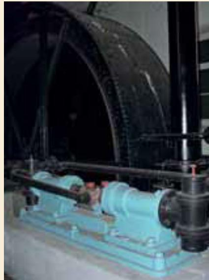
5.1.12 | Die Doppelkolbenpumpe (blau) wurde mittels Pleuelstange von dem großen, stählernen Wasserrad angetrieben. (CM.2001)
