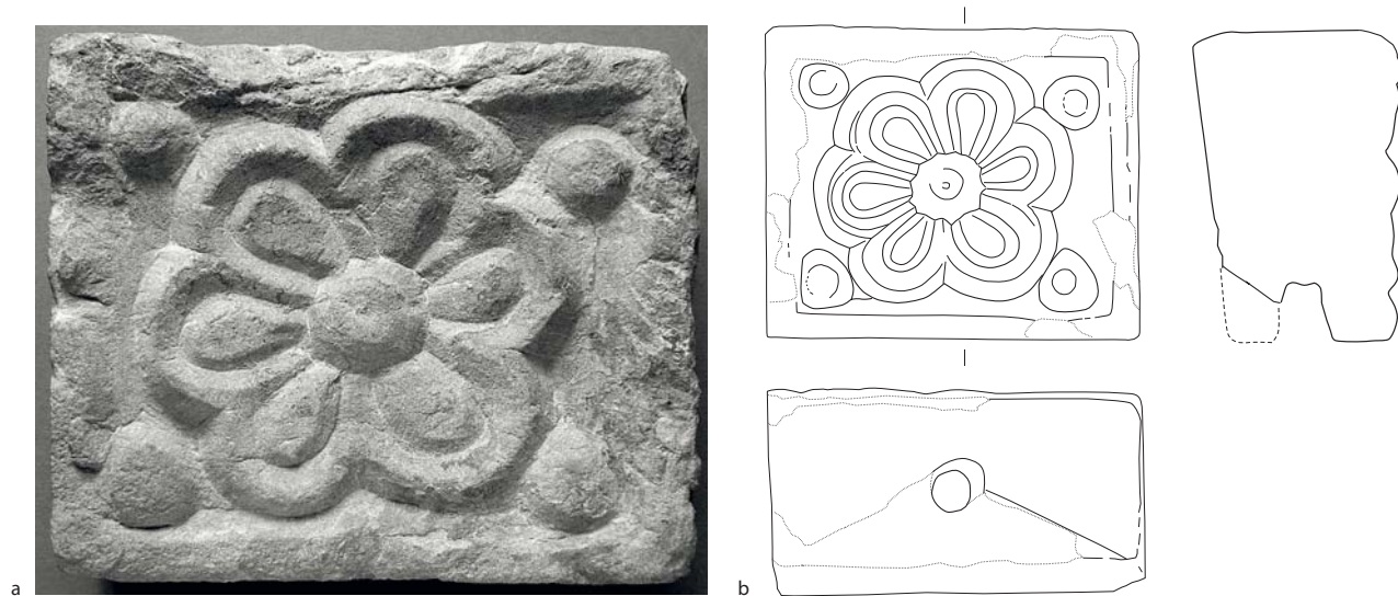
Abb. 1.1: Rosettenstein SG2187; a) skulptierte Seite, Vorderseite A; b) zeichnerische Dokumentation: oben links Seite A; oben rechts schematischer Schnitt; unten Seite D2 (Unterseite); Foto ca. 1 : 2, Zeichnung 1 : 5
