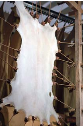
Holzrahmen zur Spannung und Bearbeitung der Tierhaut
